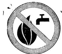
**«ЗАПРЕЩАЕТСЯ ТУШИТЬ ВОДОЙ»** - устанавливают у входа в помещения и места, предназначенные для хранения и работы с материалами,
