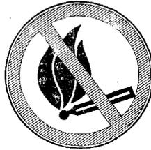
**«ЗАПРЕЩАЕТСЯ ПОЛЬЗОВАТЬСЯ ОТКРЫТЫМ ОГНЕМ»** — устанавливают на наружной стороне дверей складов с воспламеняющимися и взрывоопасными материалами и веществами, внутри этих складов, на таре для хранения и транспортировки воспламеняющихся и взрывоопасных веществ, на оборудовании, представляющем опасность взрыва или воспламенения.
