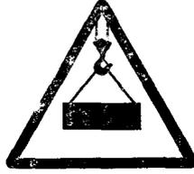
«**ОСТОРОЖНО! РАБОТАЕТ КРАН**» - устанавливают вблизи опасных зон на участках и в цехах, где используют подъемно-транспортное оборудование.
