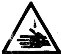
**«ОСТОРОЖНО! ЕДКИЕ ВЕЩЕСТВА»** — устанавливают на дверях складов, внутри складов, в местах хранения, на участках работ с едкими веществами, на таре для хранения и транспортировки едких веществ (щелочи, кислоты).
