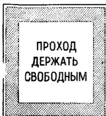
**«ПРОХОД ДЕРЖАТЬ СВОБОДНЫМ!»** - устанавливают на путях подхода к местам размещения пожарной техники и к эвакуационным или запасным выходам.
