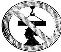
**«СТОЯТЬ ПОД ГРУЗОМ ЗАПРЕЩЕНО»** — устанавливают на отдельных элементах конструкций грузоподъемных машин и механизмов.
