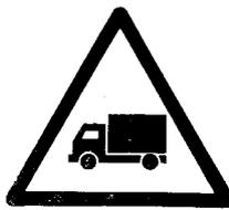
«**БЕРЕГИСЬ АВТОМОБИЛЯ!**» — устанавливают на территориях и в производственных помещениях в местах, где осуществление технологического процесса связано с постоянным движением автомобильного транспорта.
