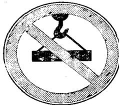
**«ПОДЪЕМ И ПЕРЕМЕЩЕНИЕ ГРУЗА ЗАПРЕЩЕНЫ»** — устанавливают у объектов, не подготовленных к транспортировке, подъем и перемещение которых связаны с опасностью.
